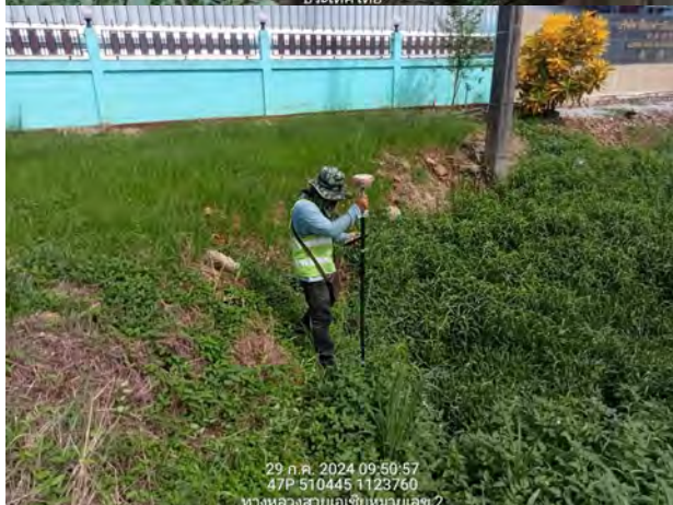
รูปที่ 4.3-3 ตัวอย่างการเก็บรายละเอียดค่าระดับของอาคารระบายน้ำด้วยวิธี RTK
